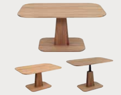
Wildeiche massiv, geölt, Bodenplatte lamellenverleimt, auf Rollen, mit Ilse-Lift-Mechanik schwarz lackiert, 53 - 72 cm stufenlos höhenverstellbar.
